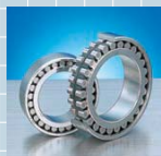
双列圆柱滚子轴承 高刚度 TB 系列 采用了塑料保持架的高性能规格 • 内外圈、滚动体材料：轴承钢 (SUJ2) • 滚子引导 PPS 树脂保持架
