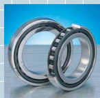
超高速单列圆柱滚子轴承 ROBUST 系列 RS 型 性价比优异的高速规格 • 内外圈、滚动体材料：轴承钢 (SUJ2) • 外圈引导 PEEK 树脂保持架
