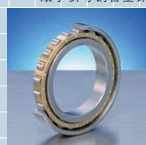
双列圆柱滚子轴承 高刚度 MB 系列 • 内外圈、滚动体材料：轴承钢 (SUJ2) • 滚子引导铜合金保持架
