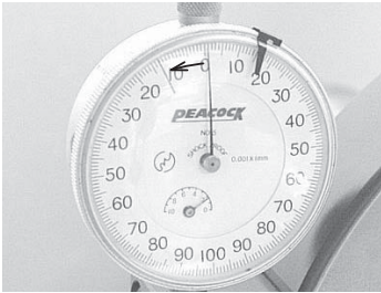
图1.10 GN量规修正量的设定
