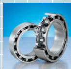
双列圆柱滚子轴承 高刚度 TB 系列 采用了塑料保持架的高性能规格 • 内外圈、滚动体材料：轴承钢 (SUJ2) • 滚子引导 PPS 树脂保持架
