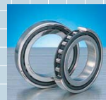
超高速单列圆柱滚子轴承 ROBUST 系列 RX 型 超高速运转时，耐热性、耐磨损性能优异的高性能规格 • 内外圈、滚动体材料：高速耐热钢 (SHX) • 外圈引导 PEEK 树脂保持架
