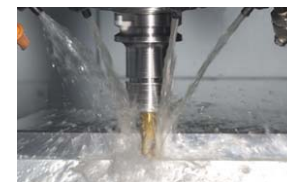
使用陶瓷球轴承的NSK主轴切削加工照片
