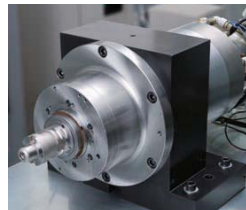
使用陶瓷球轴承，d mn 达到400万的NSK主轴
